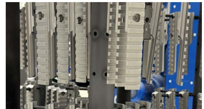
Zielfernrohrträger der MAUSER 25, bereit zum Plasmaoxidieren.
